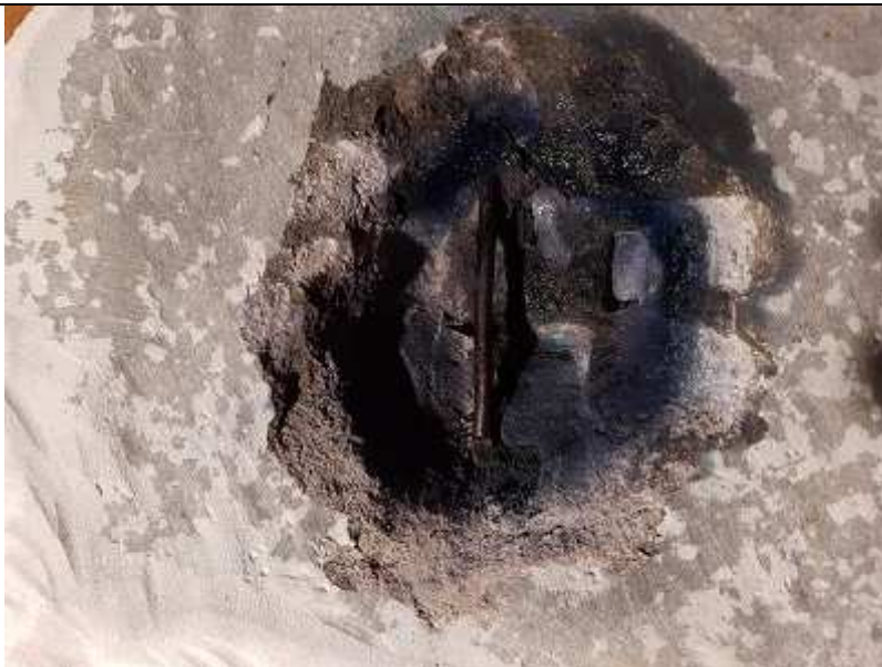
Fot. 22. Wynik Rainbow-Testu (kolor granatowy – \text{pH} > 11 ) (praktycznie brak karbonatyzacji) – warstwa torkretu, ściana.
